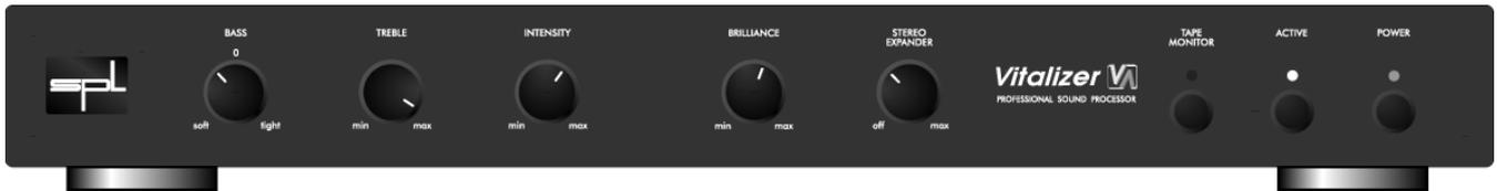
Der INTENSITY-Regler steht auf der 1:30 Uhr-Position. Die angeählte Bassklangfarbe und der Hochtonanteil werden mit einer mittleren Verstärkung versehen. Mittenfrequenzen werden ein wenig abgesenkt. Die Einstellung dieses Wertes ist stark abhängig von der Abhörlautstärke. Wenn Sie sehr leise hören, können Sie den INTENSITY-Regler weiter nach rechts drehen. Bei lautem Hören hingegen kann eine Reduzierung zurück bis zur 11 Uhr-Position nötig sein.
