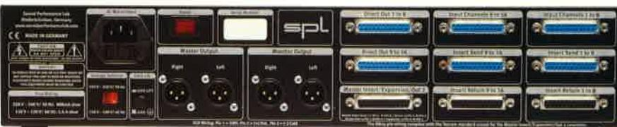
▲リア・パネル。右端には縦にインプット1～8(D-Sub25pin)、インサート・センド1～8(D-Sub25pin)、インサート・リターン1～8(D-Sub25pin)が並ぶ。その左にはインプット9～16(D-Sub25pin)、インサート・センド9～16(D-Sub25pin)、インサート・リターン9～16(D-Sub25pin)、さらに左にはダイレクト・アウト1～8(D-Sub25pin)、ダイレクト・アウト9～16(D-Sub25pin)、マスター・インサート／エクスパンション／アウト2(D-Sub25pin)が並んでいる。その左はモニター・アウトL/R(XLR)とマスター・アウトL/R(XLR)。
